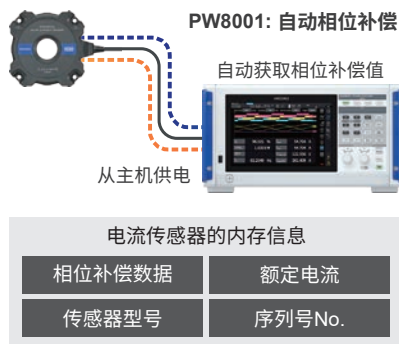
AC/DC电流传感器 CT6904A的相位特性补偿示例 (典型值)
